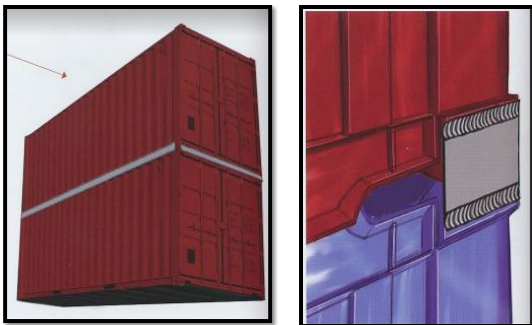
Figure 82: assemblage des conteneurs empilés
