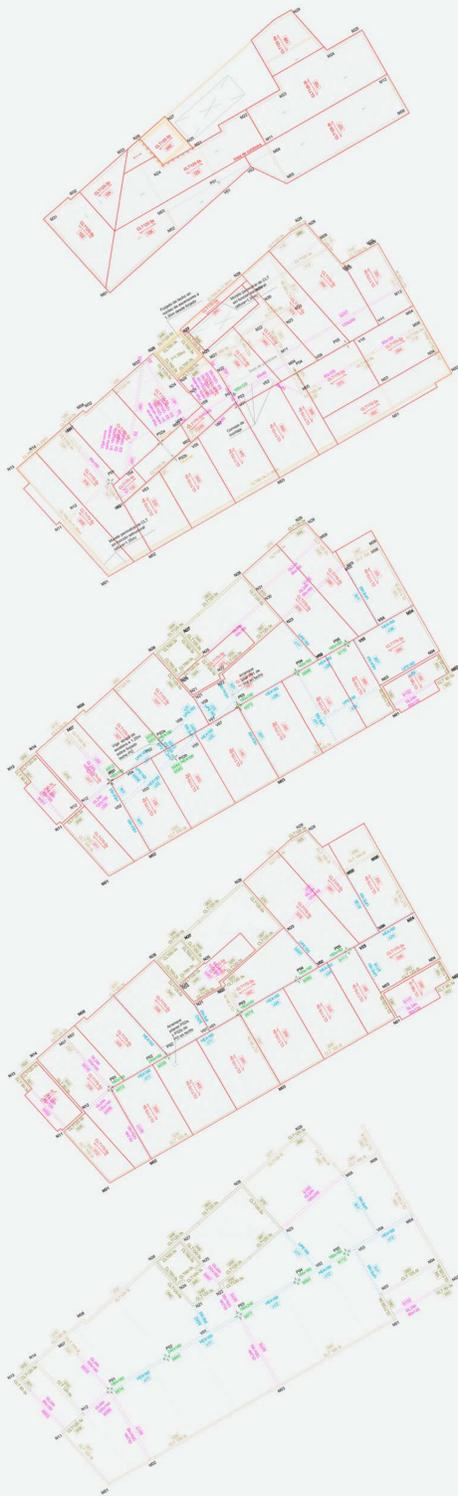
La estructura propuesta comprende de planta primera a cubierta. En planta baja se ha dejado la estructura original (porticada de hormigón armado con forjados reticulares) para dejar un zócalo de separación y por protección a fuego.
