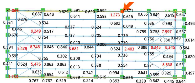
Rys. 72. Lokalizacja najbardziej wyężonego przekroju płatwi okapowej IPE 240 – hala nr 4.
