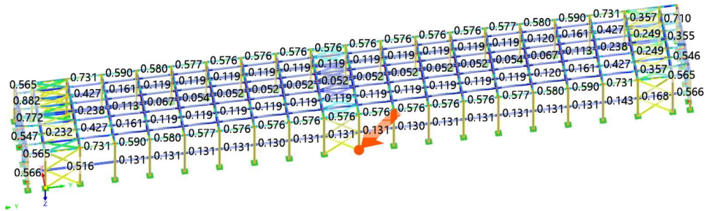
Rys. 31. Lokalizacja najbardziej wyężonego słupa HEB 220 – hala nr 2.
